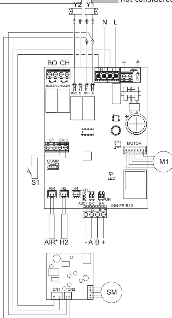
La scheda va collegata al comando remoto a muro CPD 35: un termostato elettronico (dotato di sonda di temperatura opzionalmente remotizzabile in uno dei fancoils ad esso collegati) con possibilità di controllo su uno o più apparecchi (fino ad un massimo di 30). Per le informazioni relative al CPD 35 consultare il foglio istruzioni allegato al componente.
