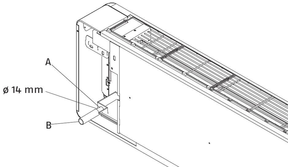
Fare attenzione all'inclinazione del tubo di scarico condensa quando viene convogliato all'esterno come in figura.
